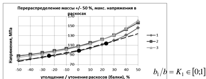
Рисунок 13 – Зміна максимальних напружень в балці (а) та в розкосах (б) при перерозподілі маси між шпренгельною системою та головною балкою для трьох характерних положень рейферного візка (дві консолі та середина прольоту)
