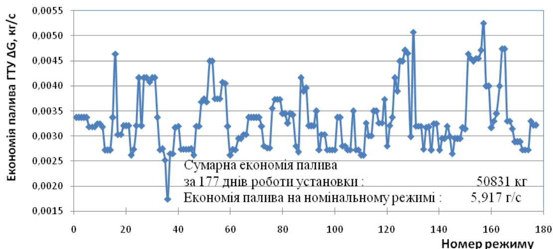
Рис. 15. Економія палива установки ГТ-750-6М по режимам роботи
