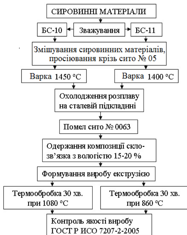
Рисунок 7 – Технологічна схема одержання розроблених склокристалічних матеріалів
