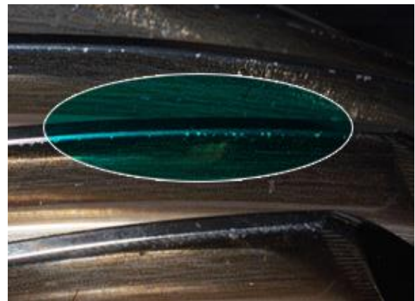
Рисунок 14 – Утворення пітінгов на поверхні зуба колеса
