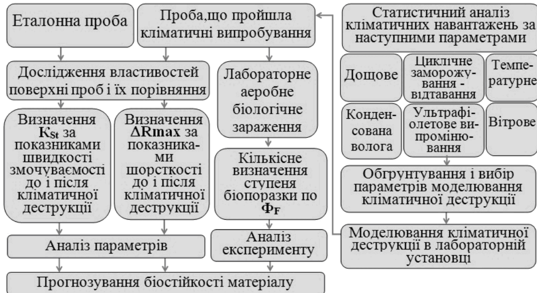
Рисунок 2 – Алгоритм експрес-тестування і методології прогнозування стійкості фасадних матеріалів до біоураження
