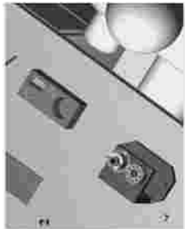
2. Встановлення корпусу блоку циліндрів
