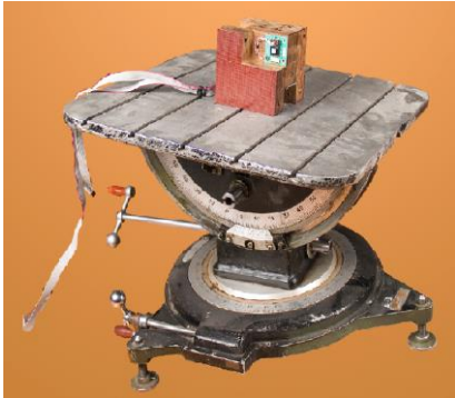
Рисунок 2 – Поворотний стіл із інерціальним модулем.
