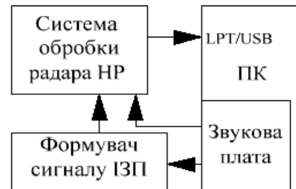
Рисунок 6 – Структурна схема програмно-апаратного комплексу для імітації НР сигналу
