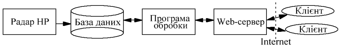
Рисунок 5 – Структура мережевої системи експрес-обробки даних радару НР
