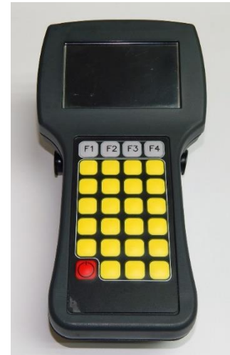
Рисунок 17 – Зовнішній вигляд розробленого товщиноміру
