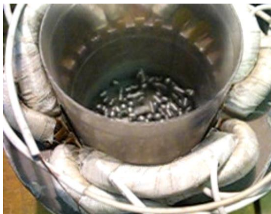
Рисунок 17 – Подрібнювач на базі ДРК, що працює при частоті живлячої мережі 50 Гц (фрагмент руху)
