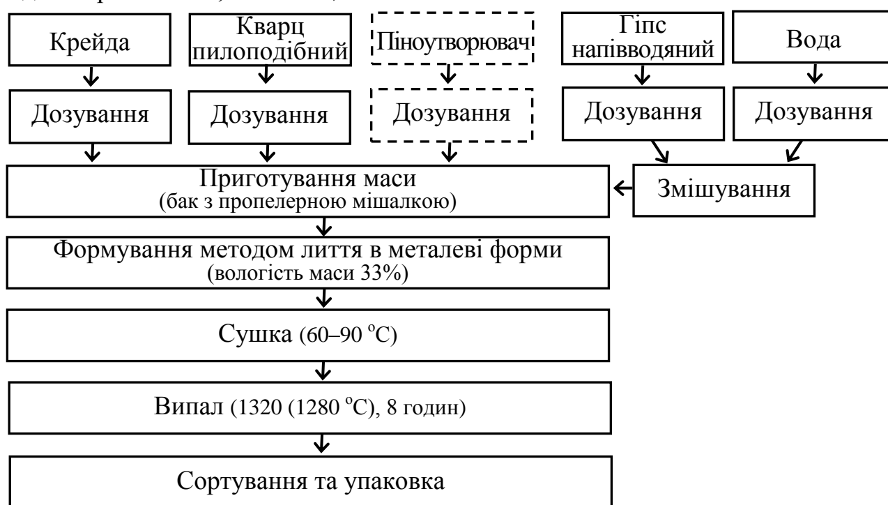
Рисунок 10 – Технологічна схема виробництва силікаткальцієвих легковагих виробів марок СКЛ-1,0 і СКЛ-0,6
