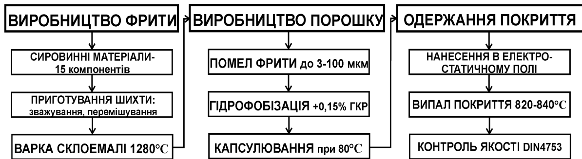
Рисунок 10 - Технологічна схема одержання безґрунтового монофритного склоемалевого покриття за технологією ROESTA
