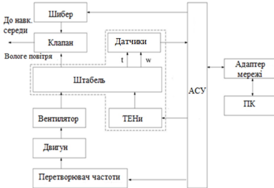
Рисунок 4 – Функціональна схема системи управління сушильної камери періодичної дії
