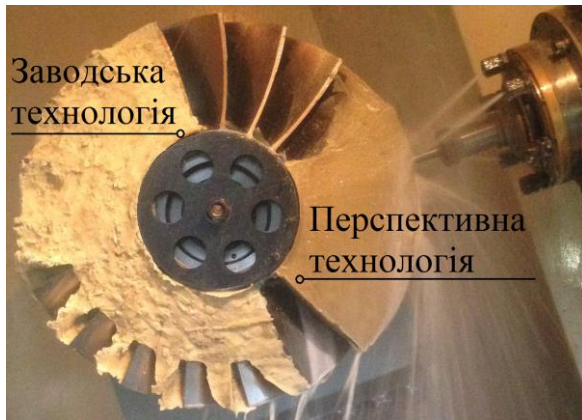
Рисунок 15 – Обробка першого рівня пера лопатки моноколеса ГТД при заповненні міжлопаткового каналу за перспективною технологією
