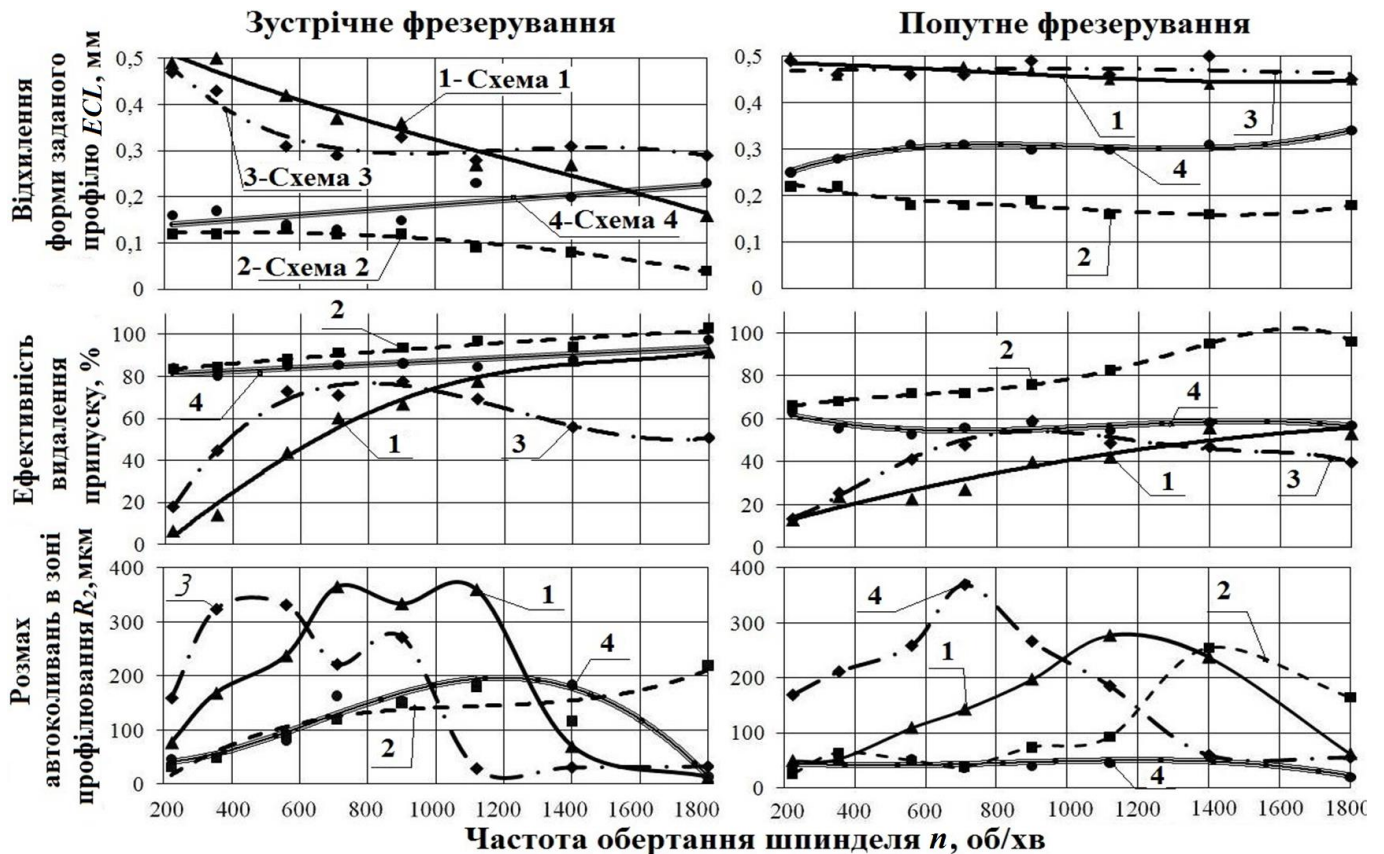
Рисунок 9 – Розмірна точність, ефективність обробки і параметри коливань під час фрезерування
