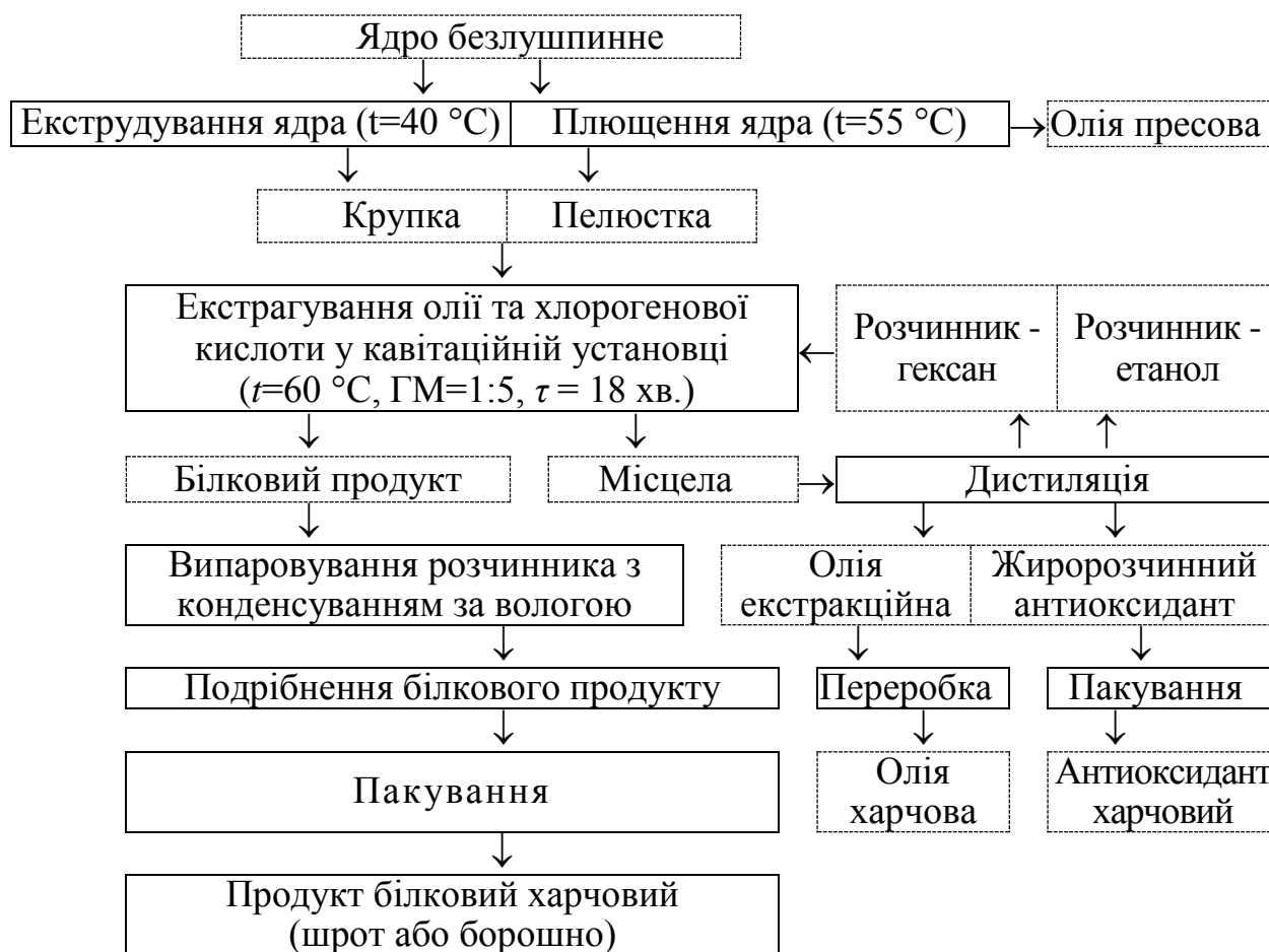
Рисунок 7 – Схема виробництва харчового білкового продукту, олії та антиоксиданту
