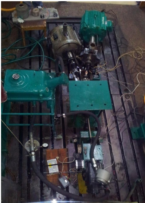
Рисунок 2 – Розроблений стенд з ГОМТ з «диференціалом на виході»
