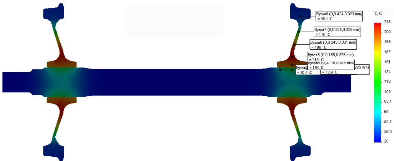
Рисунок 15 – Температурне поле колісної пари в момент скріплення коліс із віссю
