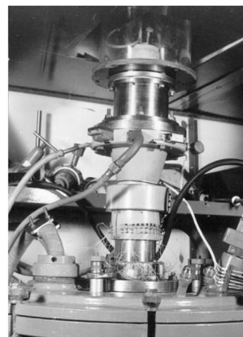
Рис.1. Низковакуумная газоразрядная электронная пушка с полым анодом
