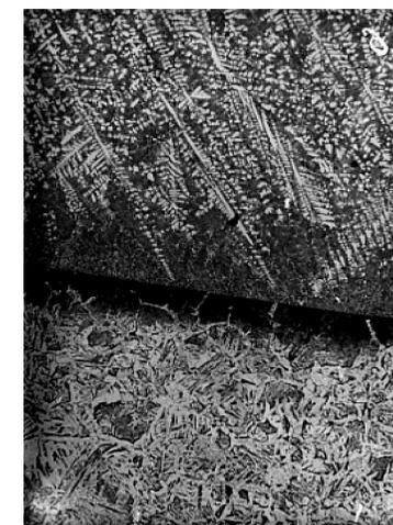
Рис.2. Микроструктура борированного слоя и подложки Ст.20, полученная при  $P_{уд} = 10^8 \text{ Вт/м}^2$ ;  $V_{ск} = 0,09 \text{ м/с}$
