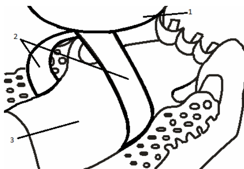
Рисунок 1 – Ливниково-живляча система для піднебінної дуги комбінованої роботи: 1 – ливникова воронка; 2 – два плоских ливника; 3 – каркас бюгельного протеза
