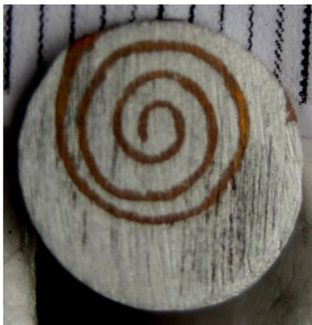
Рис. 1. Рабочая поверхность образца для испытаний на износ ( $\varnothing$  10 мм)
