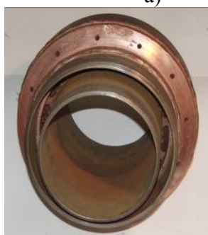
Рисунок. Схема оснащения 160-т конвертеров регулируемым подводом технологических газов (а) к верхней трехъярусной фурме и донным дутьевым устройствам (а), фото фурмы (б), верхнего 12-ти соплового блока и нижнего 12-ти соплового двухрядного наконечника (в)
