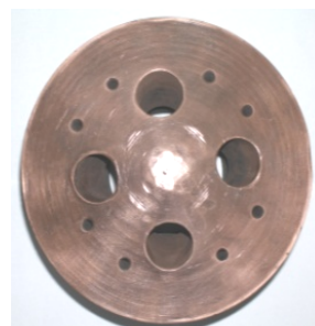
Рисунок. Схема оснащения 160-т конвертеров регулируемым подводом технологических газов (а) к верхней трехъярусной фурме и донным дутьевым устройствам (а), фото фурмы (б), верхнего 12-ти соплового блока и нижнего 12-ти соплового двухрядного наконечника (в)
