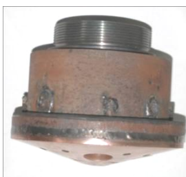
Рисунок. Схема оснащения 160-т конвертеров регулируемым подводом технологических газов (а) к верхней трехъярусной фурме и донным дутьевым устройствам (а), фото фурмы (б), верхнего 12-ти соплового блока и нижнего 12-ти соплового двухрядного наконечника (в)
