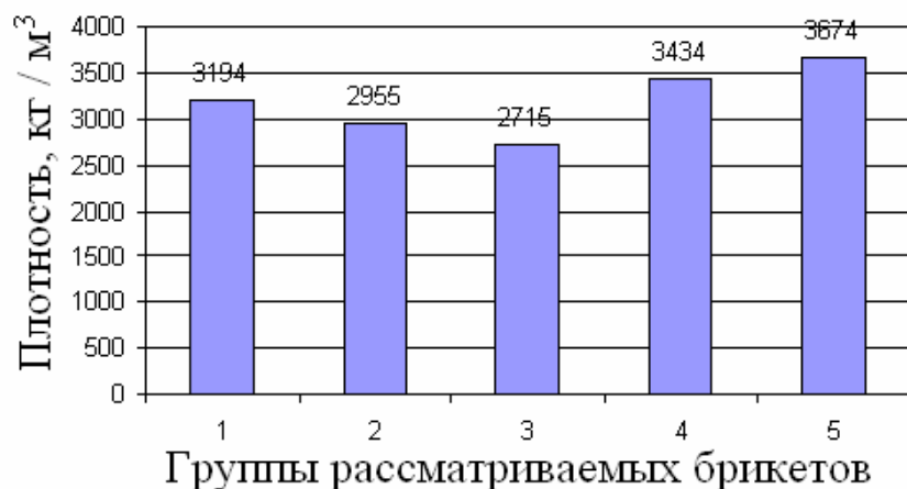
Рис. 1 Плотность брикетов различного химического состава:
