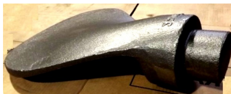
Рис. Схема заливки через приставную воронку и пример отливки лопасти.
