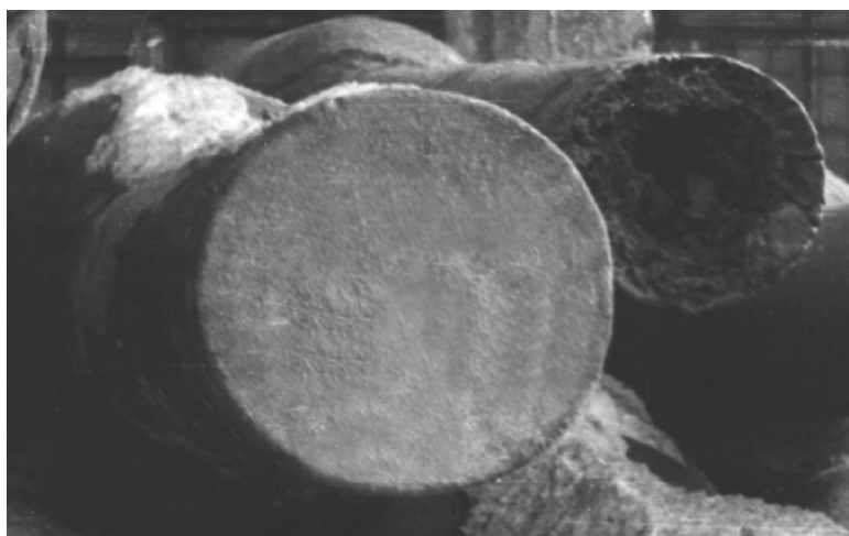
Рис. 1. Торцец прибыли прокатного валка из высокопрочного чугуна массой 26000 кг, отлитого с комбинированным электродуговым-электрошлаковым обогревом прибыли, и валков, отлитых с утеплением древесным углем и двухразовой доливкой прибыли
