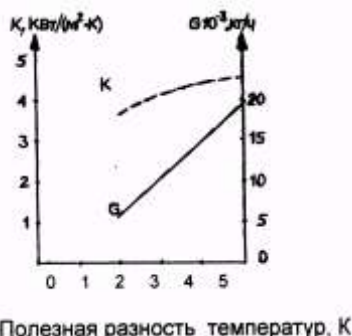
Рис. 1. Количество испаряемой воды (G) и коэффициент теплопередачи (K) в зависимости от величины полезной разности температур для пластинчатого испарителя фирмы «Альфа Лаваль»
