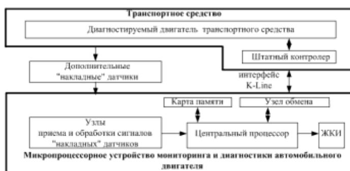
Рис. 1 Упрощенная схема диагностического прибора
