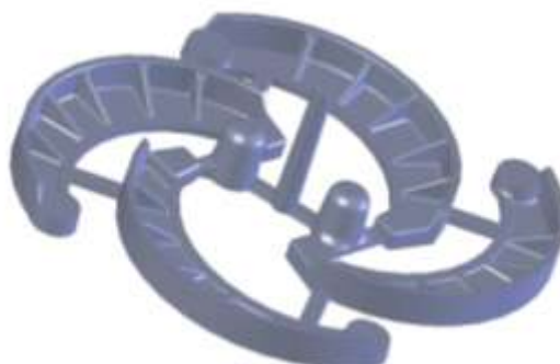
Рис.1. Тормозная колодка. 4 отливки с питателями и стояком.
