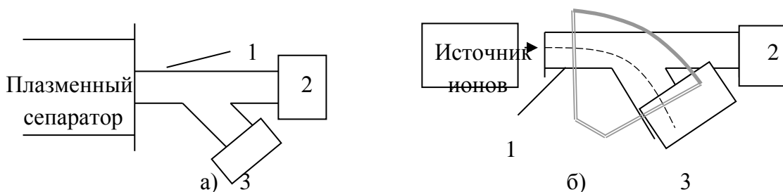
Рис. 1. Структурная схема масс-анализатора при подсоединении к сепаратору (а) и в общем случае (б)
