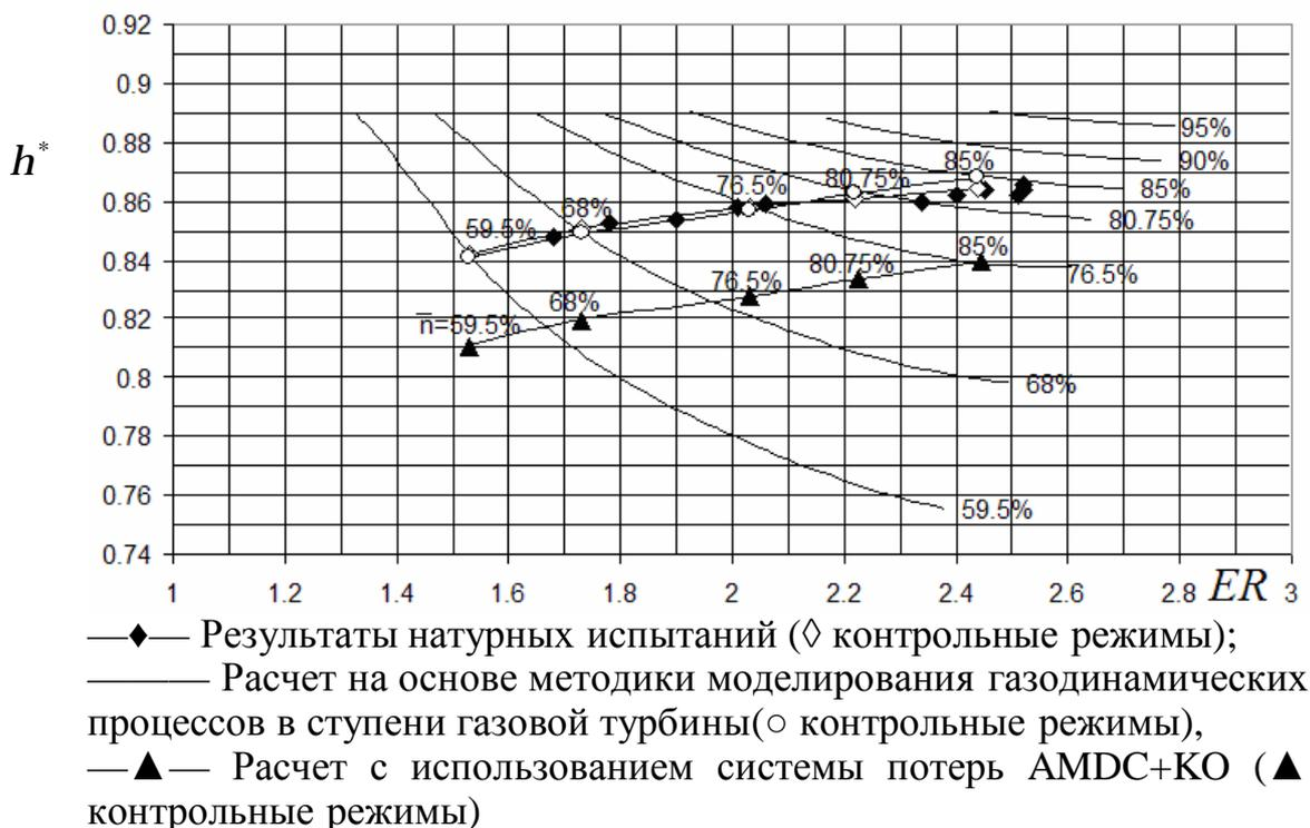
В диапазоне режимов  $ER=1,5...2,5$  и  $\bar{n}=60...85\%$  (условия проведения «горячего» эксперимента) погрешность определения КПД по предложенной методике не превышает  $\pm 0,5\%$ . Полученные экспериментальные результаты также показали, что для турбин, имеющих современные трансзвуковые решетки профилей, широко используемые системы потерь не дают удовлетворительной точности в определении потерь решеток и КПД турбины в целом (занижение КПД  $\sim 3\%$ ).
