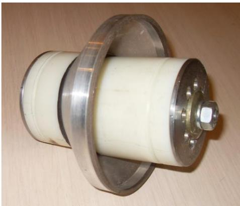
Перед операцией МДО-модернизации ШК альтернативно тонкой доводочной послеоперационной механической обработке может быть выполнено предварительное расшлифовывание его посадочного отверстия с учетом поверхностного приращения исходного тела с алюминиевой основой в оксидированном объеме и, соответственного изменения (увеличения) его линейной размерной
