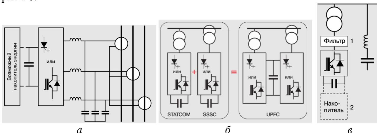
Рисунок 1 – Схема устройств FACTS
