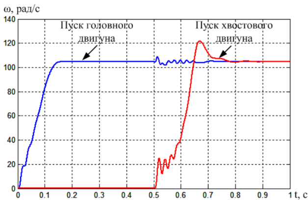
Рисунок 2 – Швидкості головного та хвостового асинхронних двигунів при послідовному пуску
