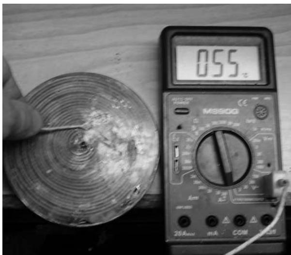
Рис. 13. Измерение температуры обмотки индуктора термопарой
