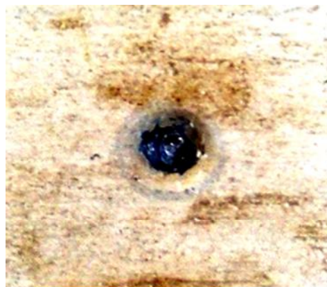
Рис. 19. Внешний вид внутренней зоны частичного проплавления образца из алюминиевого сплава АД5М толщиной 5 мм от совместного воздействия на него импульсной А- и длительной С- компонент тока искусственной молнии
