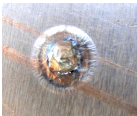
Рис. 15. Внешний вид внутренней зоны сквозного проплавления образца из алюминиевого сплава А0М толщиной 3 мм от действия длительной С- компоненты тока молнии
