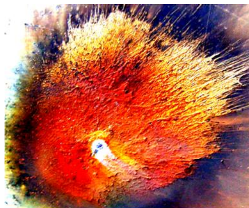
Рис. 18. Внешний вид наружной зоны частичного проплавления образца из алюминиевого сплава АД5М толщиной 5 мм от совместного воздействия на него импульсной А- и длительной С- компонент тока искусственной молнии
