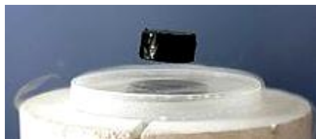
Рис. 8. Внешний вид постоянного магнита, левитирующего в воздухе над охлажденным жидким азотом N (с температурой кипения в 77,4 К) сверхпроводником из керамики [7]
