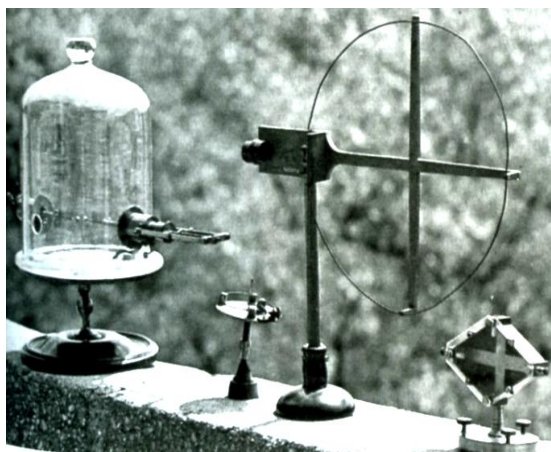
Рис. 4. Внешний вид уникальных элементов высоковольтной электроустановки Г. Герца для получения им в 1888 году в лабораторных условиях электромагнитных волн [2]
