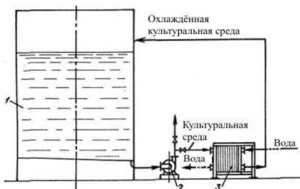
Рисунок 2 – Схема охлаждения культуральной среды с использованием выносного пластинчатого теплообменника:
