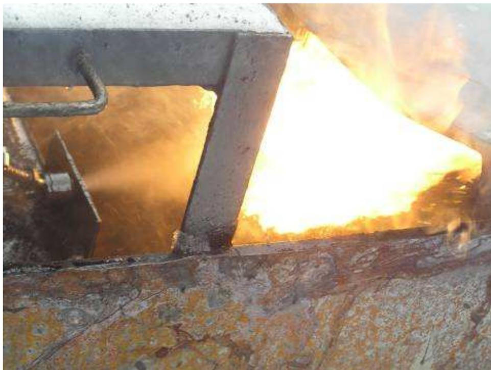
Рисунок 10 – Сжигание ИКЖТ с помощью смесителя-форсунки
