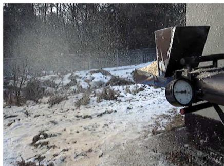
Рисунок 3 – Распыл древесной стружки с использованием эжекторного сопла
