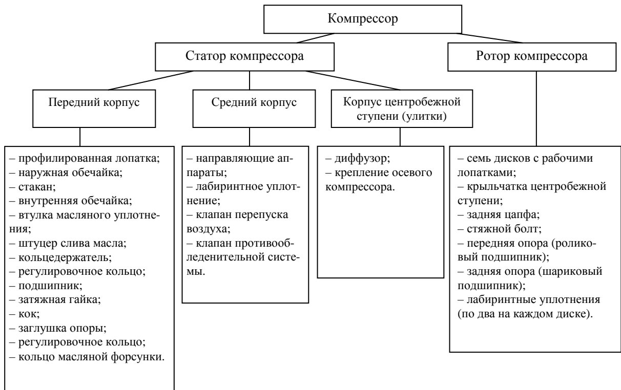
Рисунок 6 – Структурная схема компрессора АД ГТД-350
