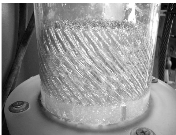
Рисунок 2 – Лабораторний стенд із сітчастими ґратами і стабілізатором пінного шару DYNAMIX, W_r = 0,5 м/с
