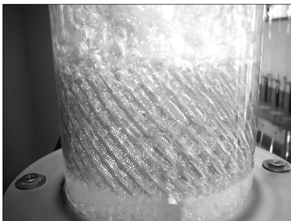
Рисунок 1 – Лабораторний стенд із сітчастими ґратами і стабілізатором пінного шару DYNAMIX, W_r = 1,7 м/с
