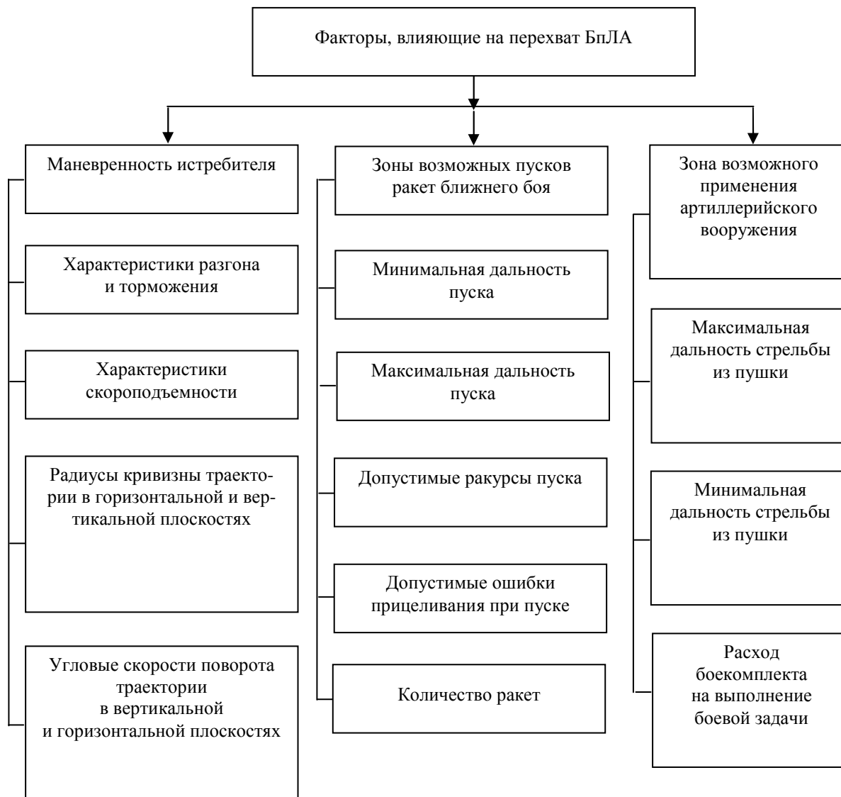
Рисунок 2 – Факторы, влияющие на выполнение задачи перехвата БпЛА
