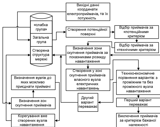
Рисунок 2 – Алгоритм визначення проміжних вузлів навантаження у складі алгоритму на основі потенційної функції
