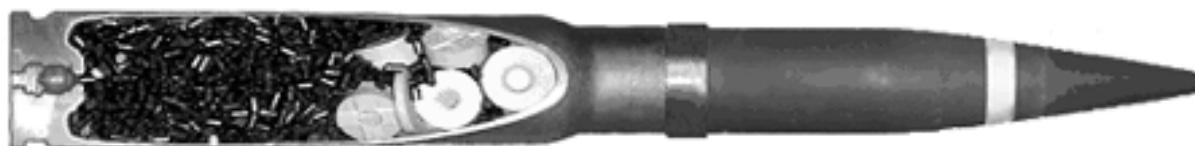
Рисунок 4 – Патрон 30мм: штатный порох частично замещен несколькими различными пороховыми N&L-элементами
