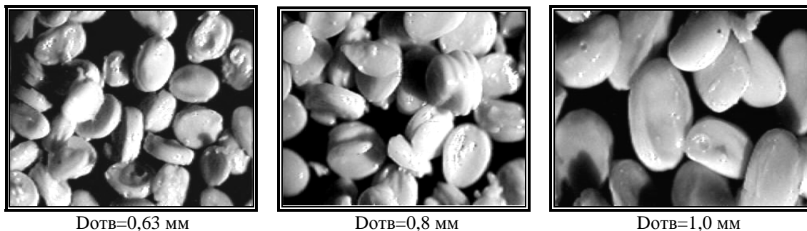
Рисунок 5 – Зміна форми гранул при різних діаметрах отвору матриці
