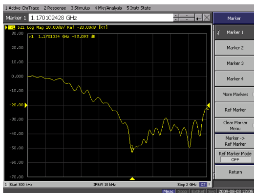
Рисунок 12 – Экспериментальная зависимость параметра S_{21} коаксиального кабеля РК-75-4-11, размещенного в высокопроводящем грунте, после воздействия МЭМИ
