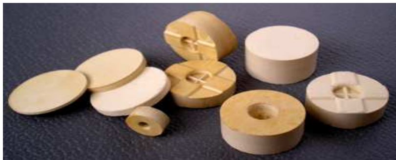
Рисунок 1 – Примеры пороховых элементов для охотничьего ружья 12 калибра и ПМ (9-мм), изготовленных по N&L-технологии
