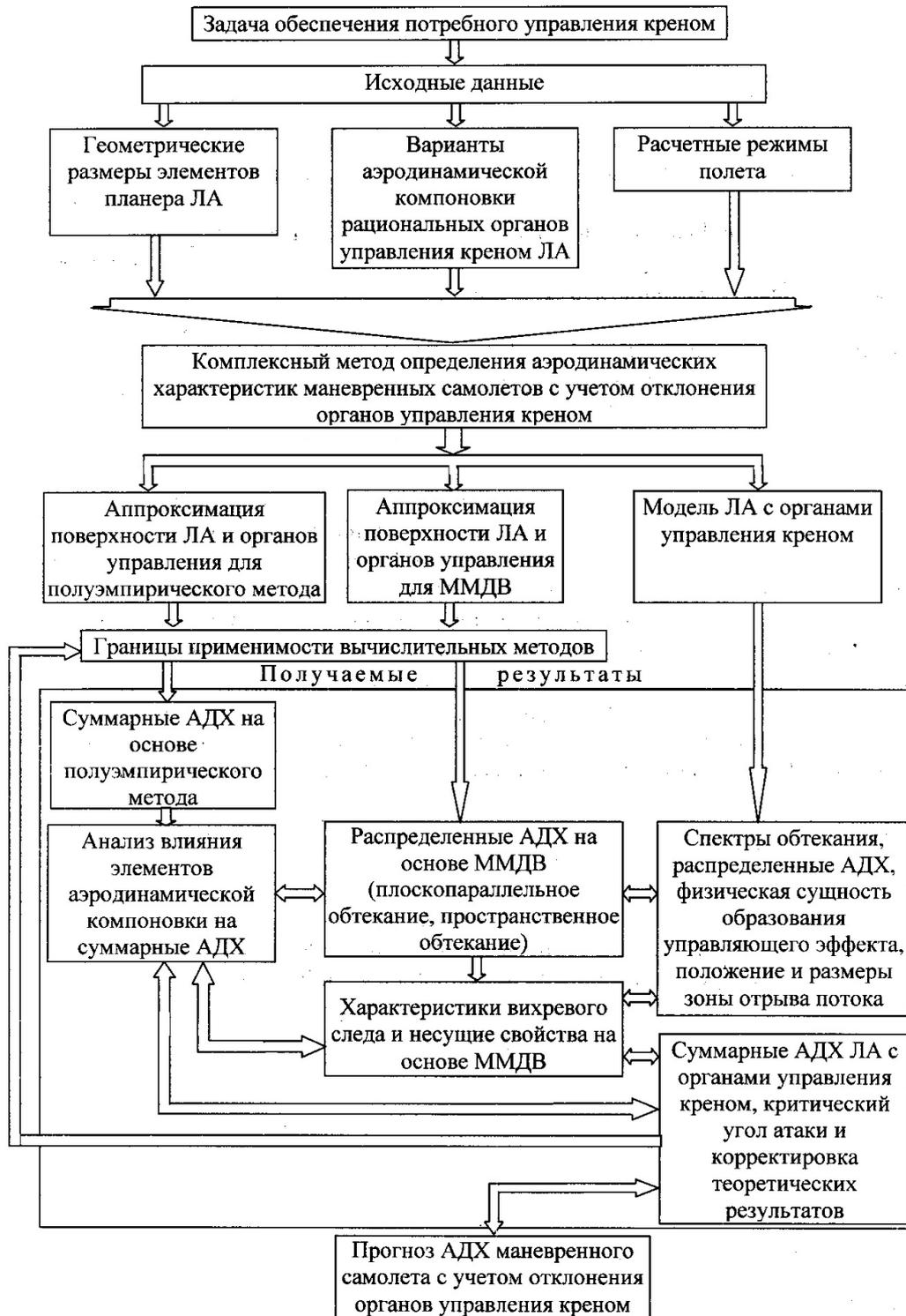
Рисунок 8 – Структурно-логическая схема комплексного метода определения аэродинамических характеристик маневренных самолетов с учетом отклонения органов управления креном
