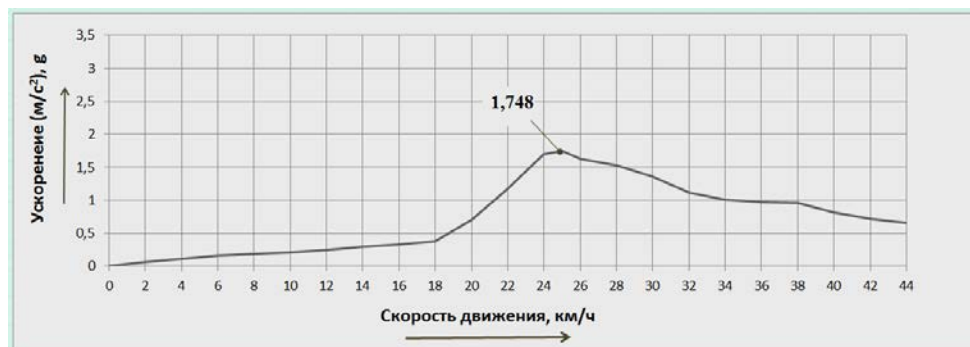
Рисунок 5 – СКО вертикальних ускорень на місці механіка-водителя/екіпажа при русі изделия БТР-4 с управляемыми амортизаторами по стандартной трассе
