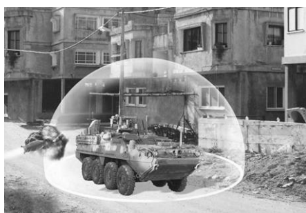
Рисунок 2 – Принцип действия КАЗ Trophy
