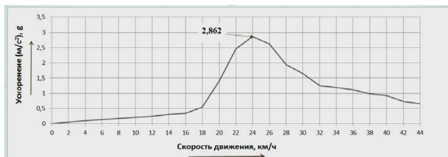
Рисунок 4 – СКО вертикальних прискорень на місці механіка-водителя/екіпажа при рухванні изделия БТР-4 по стандартній трасі
