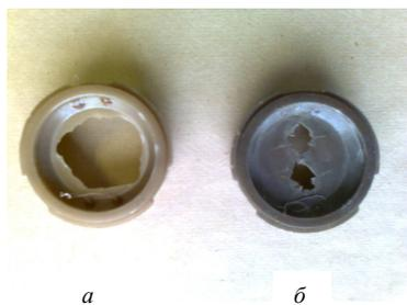
Рисунок 5 – Открытие диафрагм после подрыва электрозапалов:
