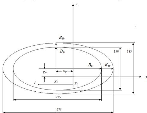
Рисунок 6 – Эллипс полигонного рассеивания торпед с учетом геронтологических изменений АБ
