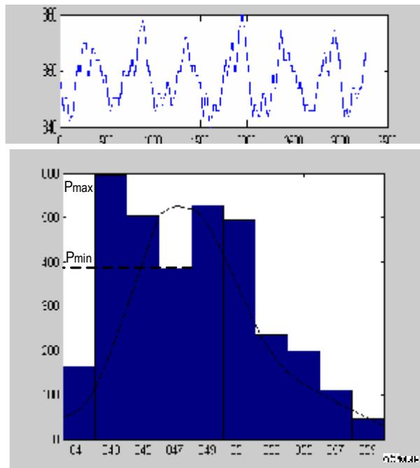
Рис. 3. Тахограмма, гистограмма и сглаживающая кривая для агрегата 10Д100 с пониженной цикловой подачей топлива
