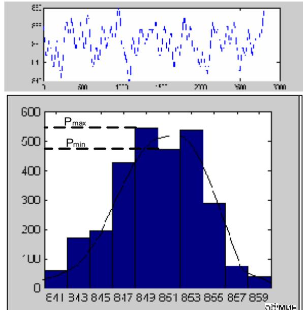
Рис.2. Тахограмма, гистограмма и сглаживающая кривая для агрегата 10Д100, имеющего дефекты в цилиндро-поршневой группе
