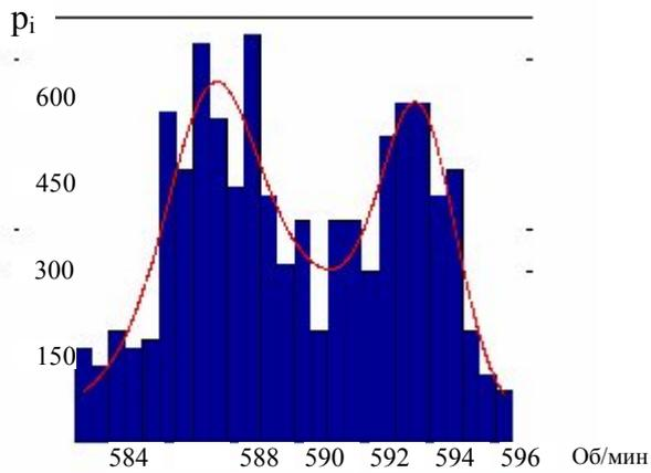
Рис.7. Гистограмма и сглаживающая кривая при отключенном втором цилиндре
