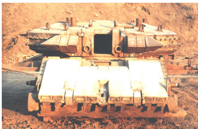
Фото 2. Носовой защитный модуль украинского танка Т-84 после воздействия ПТС
