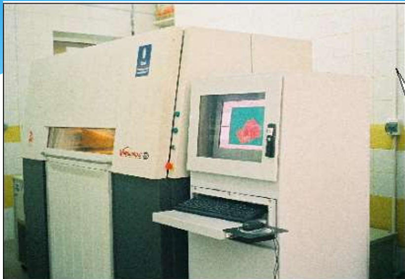
Установка для избирательного Apparatus for selective laser sintering Vanguard S12 SLS 3D Systems manufactured (USA)
