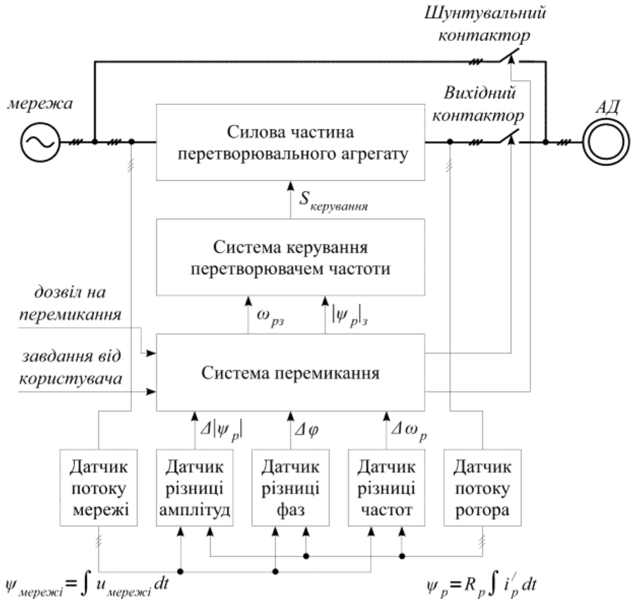
Рис. 1 Структурна схема системи керування ПА асинхронного електроприводу одиночного АД з можливістю його перемикавання на мережу та навпаки
