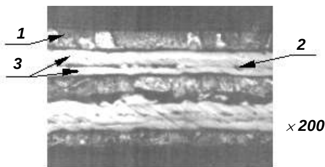
Рис. 1. Структурна будова ШКМ Cu-Ta (11,1%Ta): 1- шар міді; 2 - шар танталу; 3 - шар нікелю
